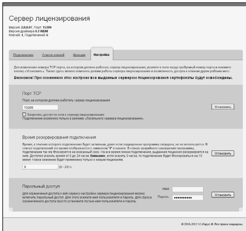
На данной закладке можно поменять номер TCP порта сервера лицензирования. Для этого следует указать новый номер порта в соответствующем поле и нажать кнопку «Установить». По умолчанию сервер подключен к сетевому порту 15200.
